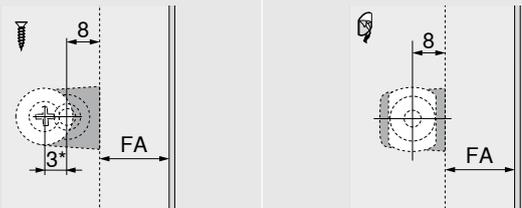
\* Pour la contreplaque à visser, nous préconisons un positionnement décalé de 3 mm de l'unité TIP-ON. Dans les surfaces dures ou MDF, procéder éventuellement à un préperçage Ø 2.5 mm puis à un fraisage.
