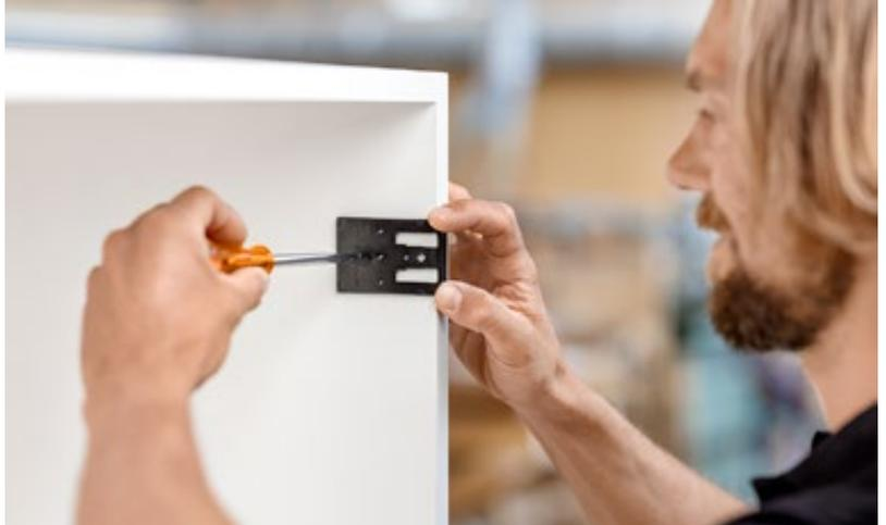
Nos aides de montage vous permettent par exemple de positionner et de fixer le réservoir de force AVENTOS sur le corps de meuble. Un alignement optimal vous permettra de garantir le bon fonctionnement des ferrures. Ainsi, vos clients apprécieront pleinement de pouvoir ouvrir et fermer leur meuble sans encombre.
