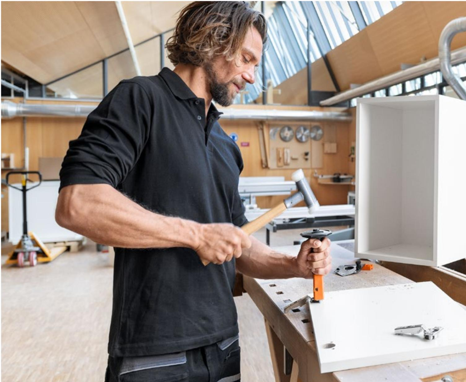
La mise en œuvre et le montage de nos systèmes de charnières sont simples et rapides, surtout si vous utilisez nos aides de montage. Par exemple, lors de la préparation du corps de meuble, le pointage et le perçage se font en un tour de main. Vous pouvez ainsi poser les portes avec précision et sans effort, ce qui vous fait gagner du temps.
