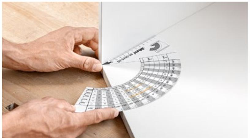
Pour le montage des faces, notre gamme comporte d'autres aides de montage. À titre d'exemple, nous pouvons citer nos gabarits de perçage pour charnières, lesquels permettent de faire coïncider exactement les positions de perçage de la face avec celles du corps de meuble. Ainsi, les charnières fonctionnent de manière optimale : les portes se ferment bien et le schéma de jeux est impeccable.
