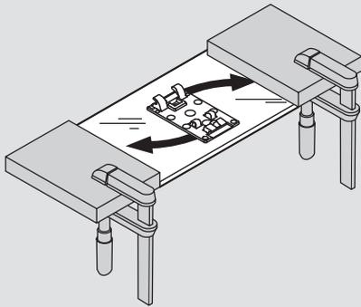
**DE** Die Befestigung der Platte zum Kleben auf Glas oder Spiegel erfolgt durch spezielle Kleber. Das Aufkleben muss von Firmen durchgeführt werden, die über das nötige Wissen verfügen (Glaserhersteller, Glasverarbeiter). Bezüglich Auswahl und Verarbeitung des Klebstoffes zur Befestigung der Platte zum Kleben auf Glas oder Spiegel wenden Sie sich an die Kleberhersteller bzw. Glas- oder Türlieferanten.
