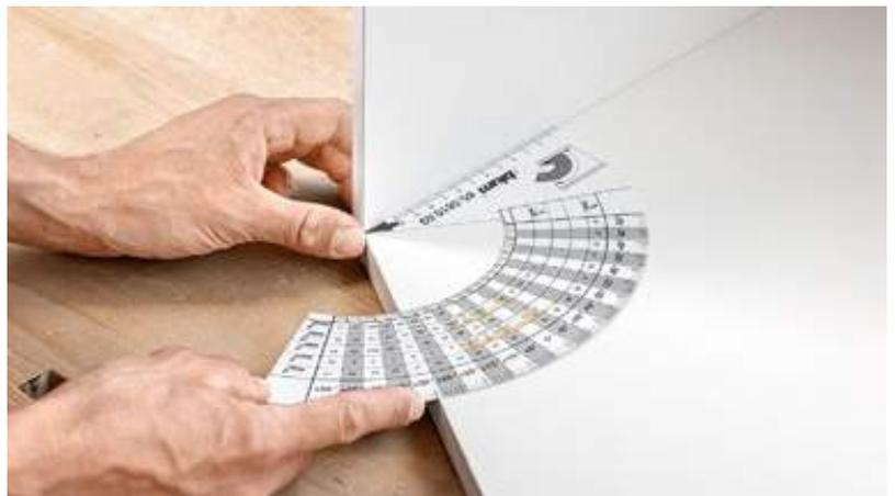
U svom asortimanu nudimo dodatna pomagala pri obradi za montažu fronti. Primjerice, naše šablone za bušenje za spojnice. One osiguravaju da su pozicije za bušenje na fronti usklađene s pozicijama za bušenje na korpusu. Tako spojnice funkcioniraju optimalno: Vrata se lako zatvaraju, a izgled bočnog razmaka je besprijekoran.
