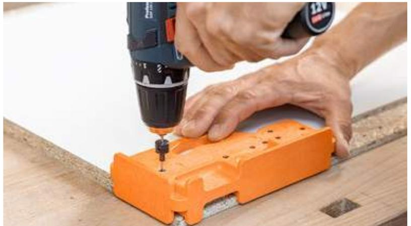
Bušenje rupa radni je korak pri kojem je važna iznimno velika preciznost. Naše šablone za bušenje uvelike pojednostavljaju označavanje i predbušenje položaja pričvršćivanja vodilica koje se pričvršćuju na korpus. U nekoliko trenutaka možete optimalno pripremiti komponente za montažu.
