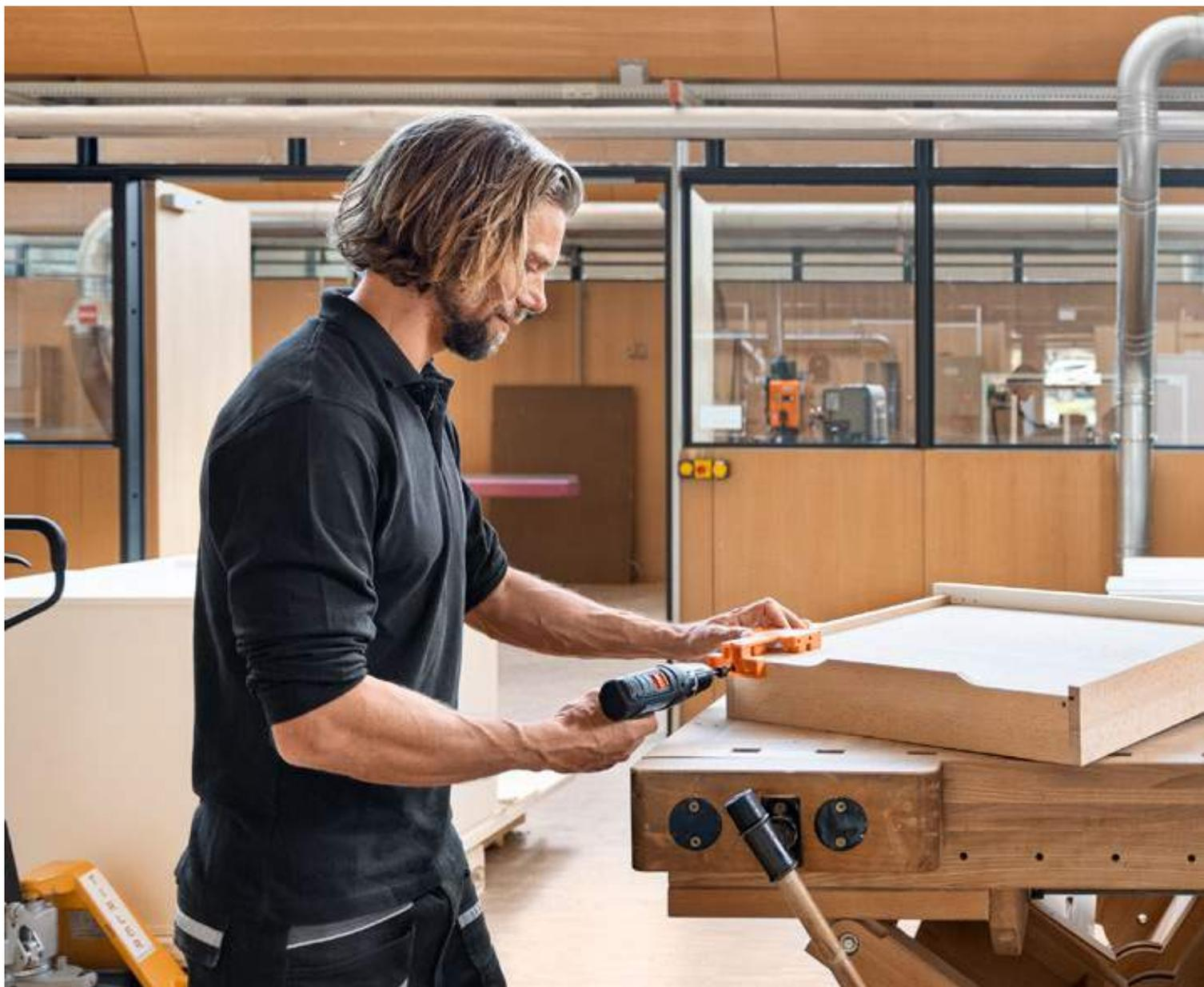
Okove je moguće još preciznije postaviti postupkom predbušenja. To je osobito prikladno kad se radi o drvetu, a time i prilikom pričvršćivanja vodilice na ladicu. Točnu poziciju za bušenje posebno učinkovito možete odrediti pomoću naših šablona za bušenje. To možete učiniti još jednostavnije upotrebom stroja MINIPRESS top. Pravilnim postavljanjem ladicica na vodilice osiguravate nečujno kretanje.
