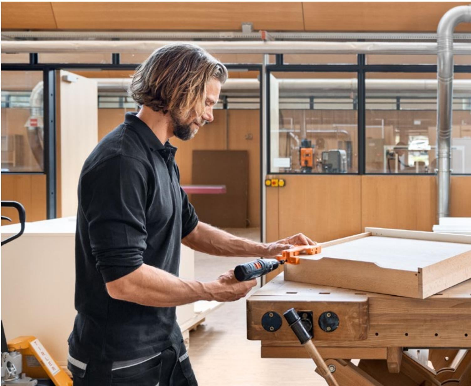
Durch Vorbohren lassen sich Beschläge noch genauer setzen. Dies ist vor allem bei Holz sinnvoll und somit auch bei der Befestigung der Führungsschiene am Schubkasten. Die genaue Bohrposition ermitteln Sie mit unseren Bohrlehren besonders effizient. Und noch einfacher geht es mit MINIPRESS top. Sitten Ihre Schubkästen korrekt auf der Führungsschiene, gewährleisten Sie einen schwebeleichten Lauf.
