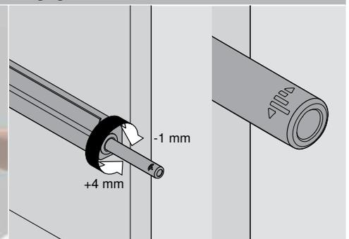
Le support d'ouverture optimal est assuré lorsque l'unité TIP-ON est fixée dans la bonne position de la poignée.
