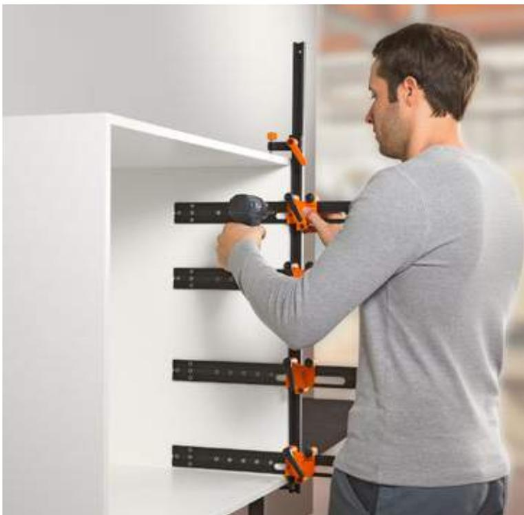
Blum은 간단하고 효율적으로 제작할 수 있는 특별한 조립 장치를 제공합니다. EASYSTICK이 장착된 MINIPRESS top 드릴링 및 삽입 머신은 조립을 지원합니다. 러너 시스템을 위한 범용, 개별 및 드릴링 템플릿, 로드와 표시 템플릿을 제공합니다. TANDEM 및 MOVENTO에 특수 템플릿도 사용할 수 있습니다.
