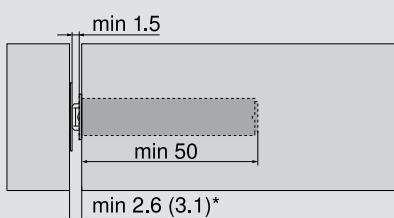
\* min. 2.6 mm s prihvatom pločicom za lijepljenje
