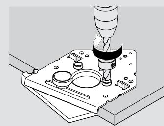
Šablona za bušenje za spojnice
