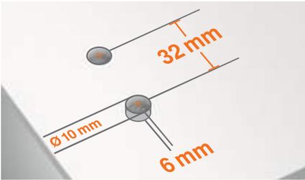
安装无需铰杯钻孔
