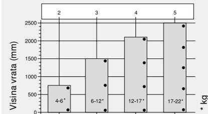
Broj spojnica ovisi o visini i težini vrata. Kako bi se postigla dobra stabilnost, potrebno je odabrati najveći mogući razmak spojnica. Podaci o opterećenju i visini odnose se na normalnu širinu vrata od 600 mm.
