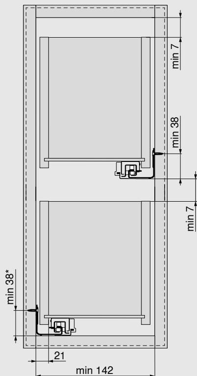
\* + 1 mm en cas de montage de la coulisse corps de meuble avant l'assemblage du corps de meuble
