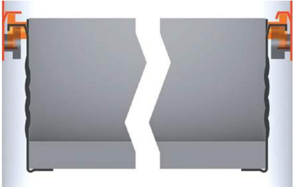
Der Toleranzausgleich erfolgt auf der linken Korpusseite. Auf der rechten Seite wird der Schubkasten bzw. Auszug seitlich stabil geführt.
